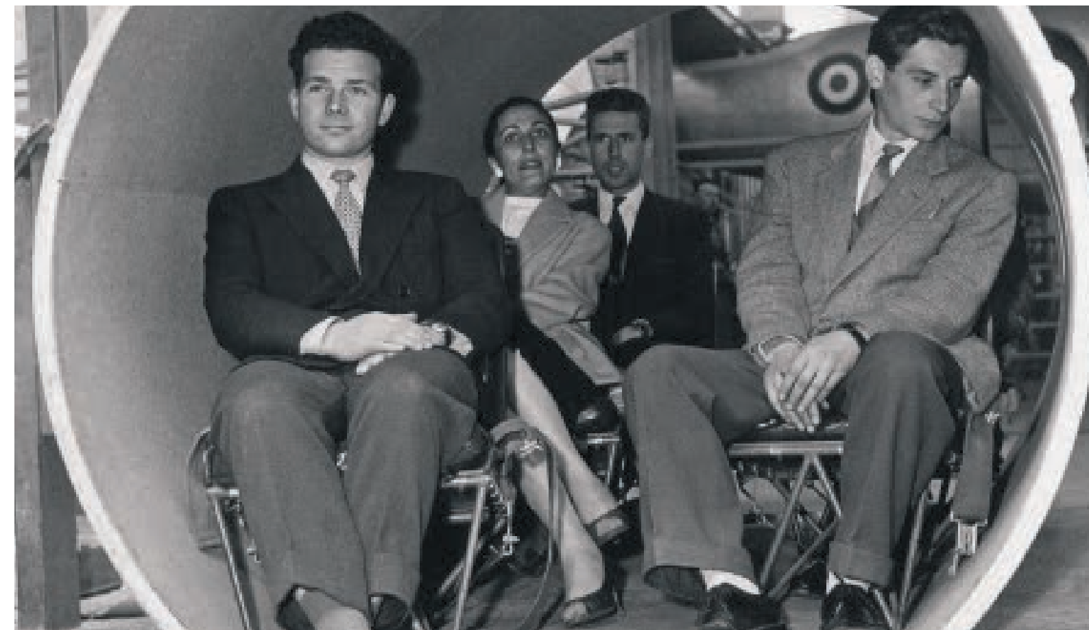
Вот так до цифрового проектирования узнавали, удобно ли будет в самолете пассажирам. На фото — сечение проектируемого самолета Meditteranee, из которого впоследствии сделали Mystere 20, первый бизнес-джет Dassault
