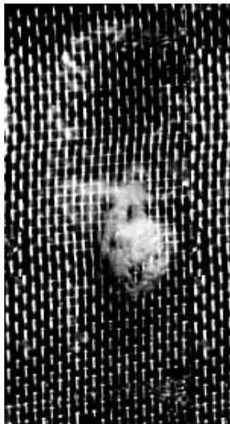
Рис. П6. Фрагмент отводного канала плоского макета насыпной ТВС; иллюстрация шаровой завихренности
