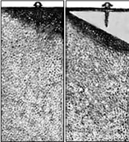
Рис. П3. Застойные зоны (темные пятна) у торцов топливного слоя насыпной ТВС
